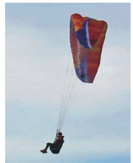
▲ Abbildung 5.12 Abstieghilfe „B-Stall“ in der Einleitungsphase
