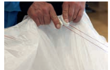
▲ Abbildung 1.11 Leinenmessung beim Gleitschirm-Check in der Werkstatt
