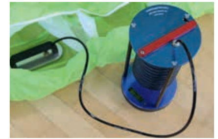
▲ Abbildung 4.7 Porositätsmessung beim „2-Jahres-Check“
